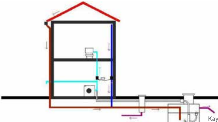
Şekil 21: Tipik yağmur suyu arıtım şeması
